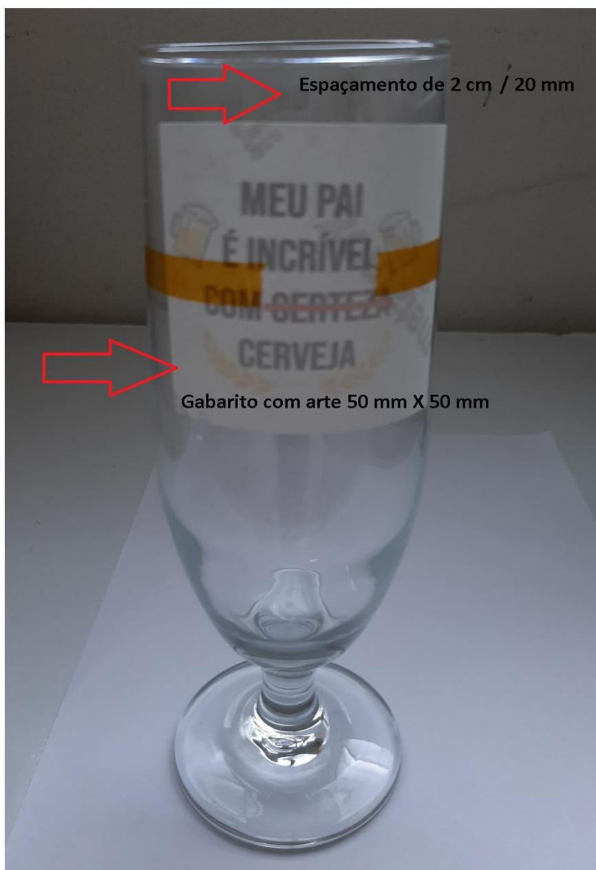
É necessário posicionar a taça aproximadamente 90 mm para dentro da máquina, verificar o “abraçamento” da taça na resistência para não ter espaçamento. Em caso de mau posicionamento terá falha na sublimação.
