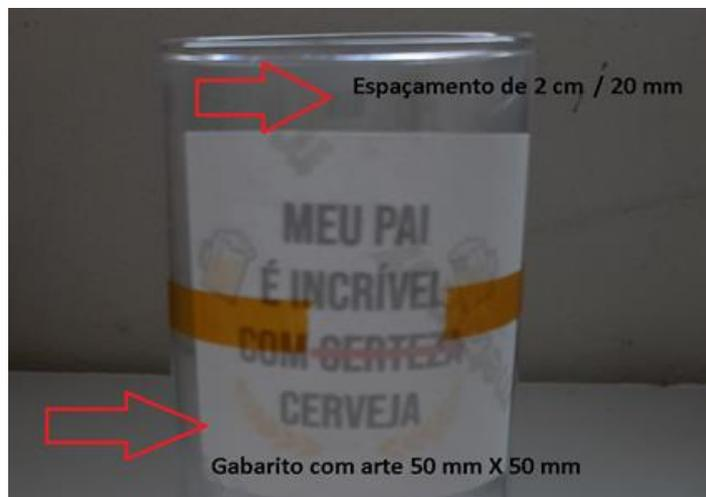
É necessário posicionar a taça aproximadamente 90 mm para dentro da máquina, verificar o “abraçamento” da taça na resistência para não ter espaçamento. Em caso de mau posicionamento terá falha na sublimação.
