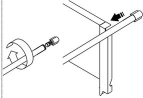
Fixe o conector no furo Ø10mm e encaixe o tubo.
