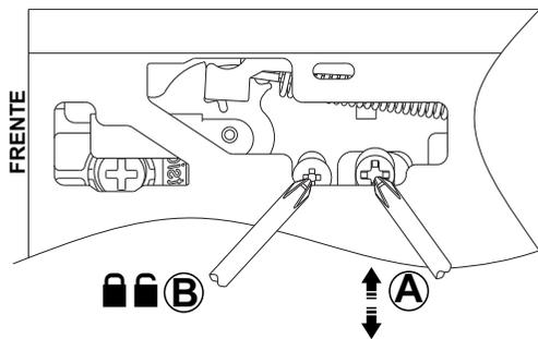
Gire o parafuso indicado para fazer o ajuste lateral para direita ou para esquerda.
